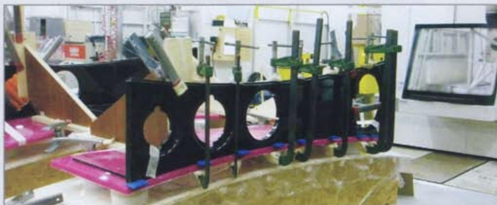
L'assemblaggio dei vari elementi che compongono le ICARUS avviene per fasi con l'impiego di collanti speciali. Delle fresature interne allo spessore permettono l'incastro dei singoli pezzi.
