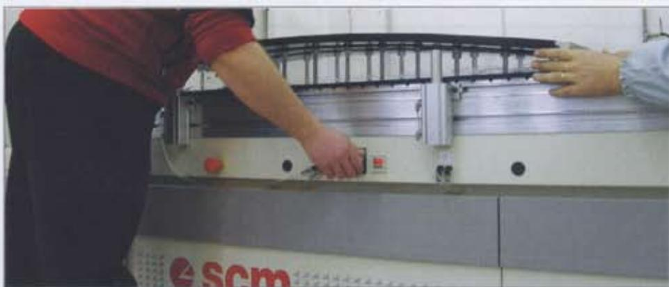
Il pannello posteriore termoformato viene posizionato su di una dima; attraverso un macchinario a controllo numerico viene realizzata la tasca (scasso) per l'alloggiamento della vaschetta destinata ad ai connettori.
