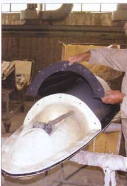
Particolari della rimozione dello stampo.
